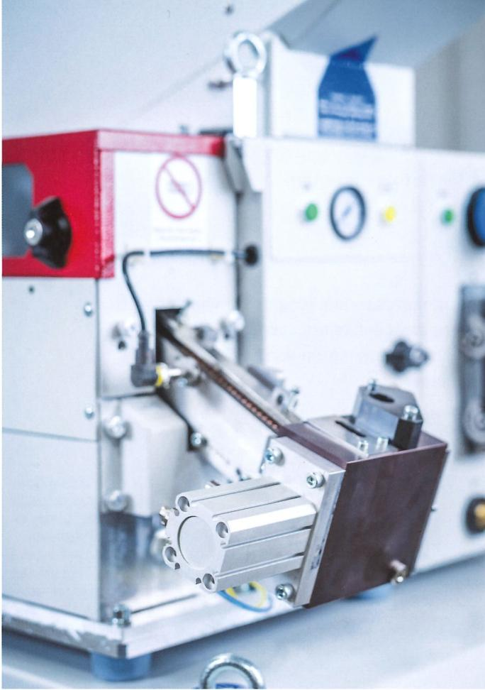
Damit der richtige Bolzen an die richtige Schweißstelle kommt, muss der Bolzensortierer FSE 1000s die unterschiedlich großen und langen Bolzen zunächst vereinzeln und „schweißfertig“ orientieren
